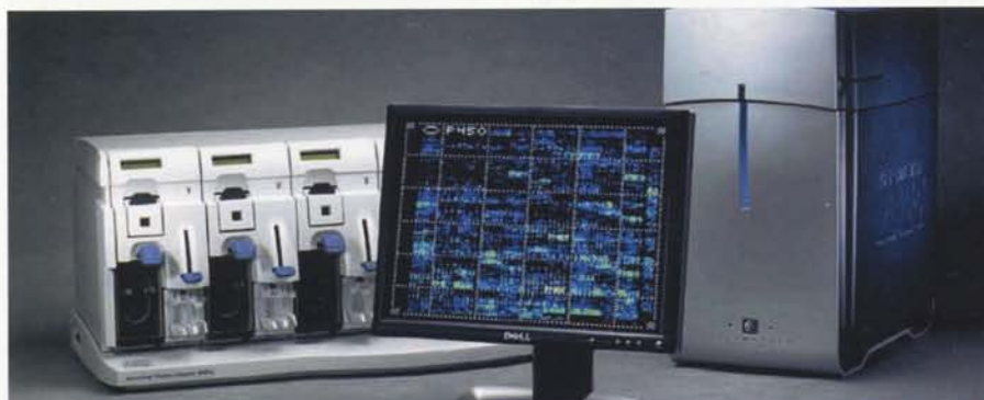
Το CG 3000 System της Affymetrix, Inc με το σταθμό έκχυσης και χρώσης (Fluidics) και το σαρωτή (Scanner)
